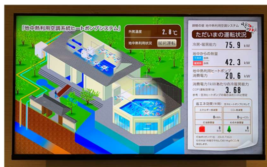
館内に設置されている地中熱の利用状況モニター
