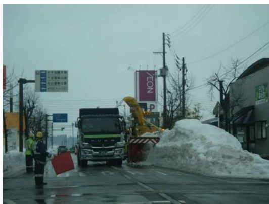
機械除雪による交通の確保
