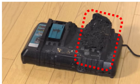
充電式電動工具用非純正バッテリーの発火 (再現イメージ)
