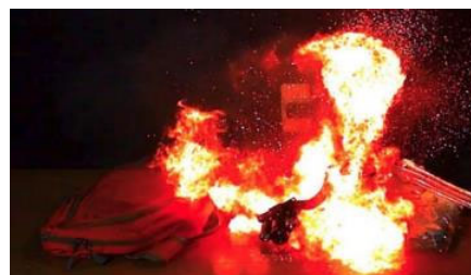
LEDヘッドライトを付属品よりも出力電圧の高い他製品の充電器で充電して発火
