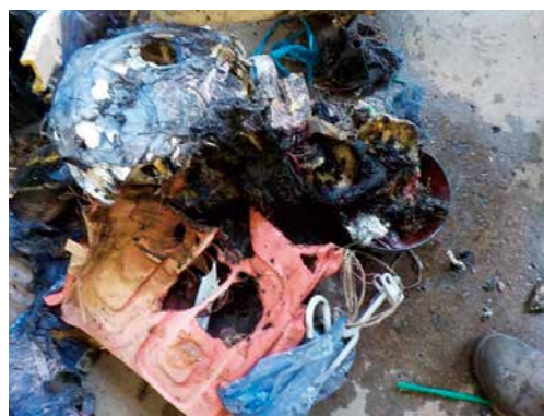
▲リチウムイオン電池の発火が原因で他のごみに燃え移った事例
