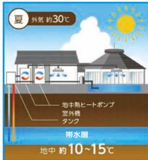
△地中熱ヒートポンプのしくみ
