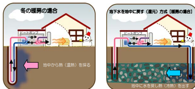
図 2-1 クローズドループ・オープンループ式の概要図 (出典：環境省、地中熱利用にあたってのガイドライン)
