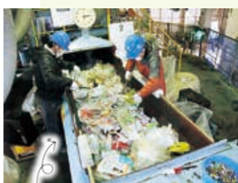
手作業で異物を取り除いています。
