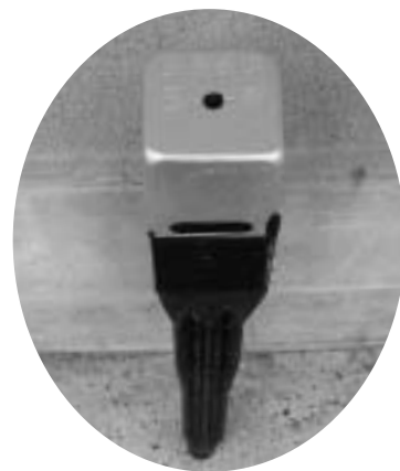
測量の基準となる図根点に埋設される杭
