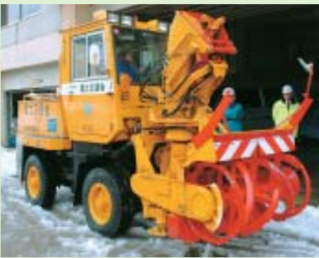
応急仮設住宅の除雪に利用される小型ロータリー車
